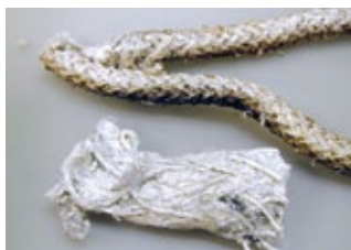
Cordons d'étanchéité en fibres d'amiante pur (source: IST)
