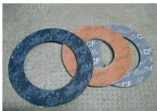
Joints en fibres d'amiante fortement aggloméré (source: IST)
